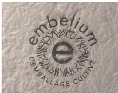
Embelium est ininflammable, il peut donc être gravé au moyen d'un laser. Une solution 100% naturelle, sans encre ni solvant.
